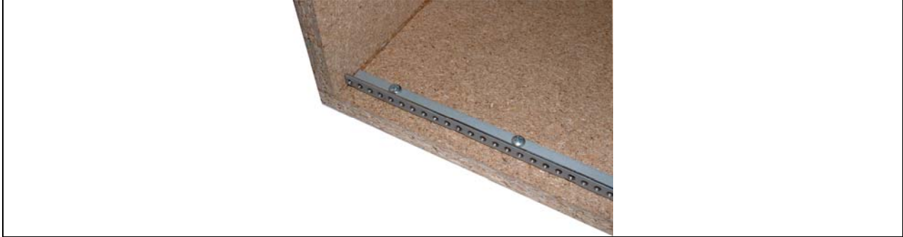
Montage der Gewindeschienen (das Bild zeigt noch die alte Version ) Die neuen Schienen werden an den Seitenteilen mit den gelieferten M5x20-Schrauben befestigt
