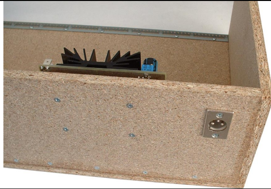
Detailansicht von hinten (mit XLR-Steckverbindung)
