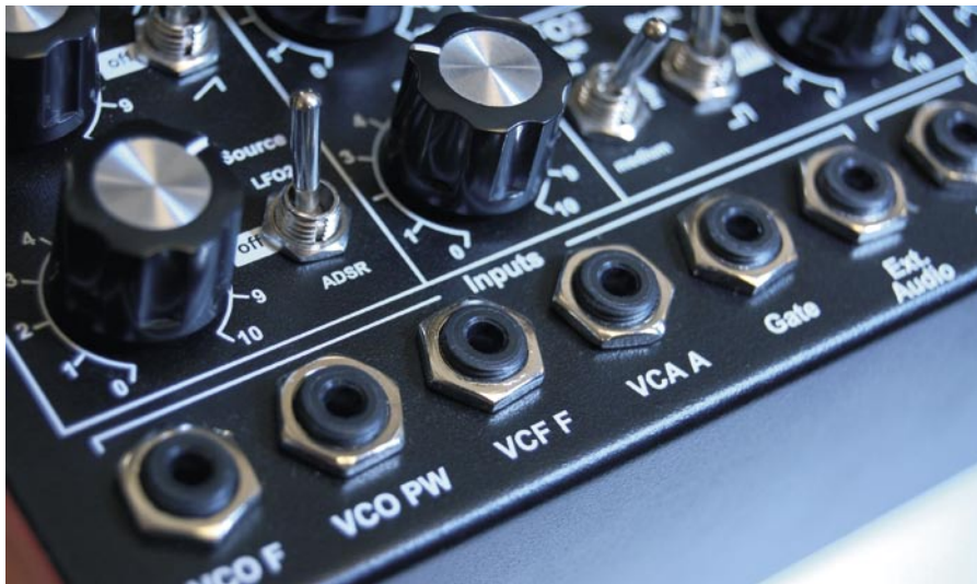
Abb: Externe Kontrolle von VCO Frequenz, PW, Filter Frequenz und VCA Gain
