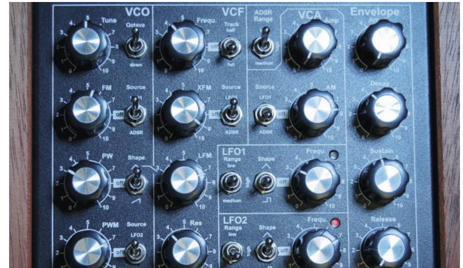
Abb: Exponentielle (XFM) und lineare (LFM) Frequenzmodulation des Filters (Bildmitte)
